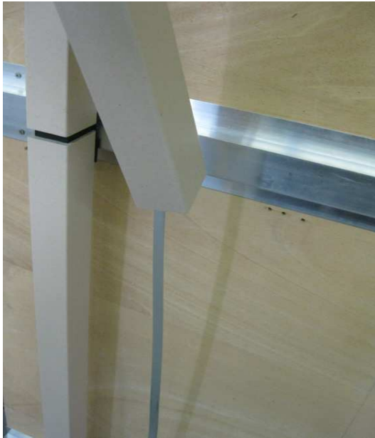
Rechteckrohr auf Al-Streifen fädeln thread the tube on the Al-stripe
