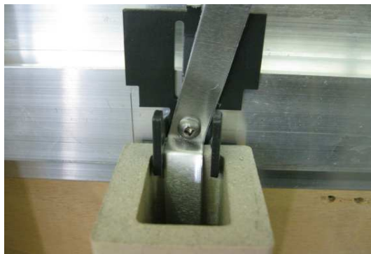
Kammer #685-5060 einstecken u. befestigen insert clamp #685-5060 and fix it
